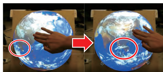
図7 半球面マルチタッチパネルの操作
