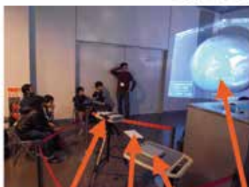
PCプロジェクター ゲームコントローラ パソコン 球形スクリーン (2m風船式)
